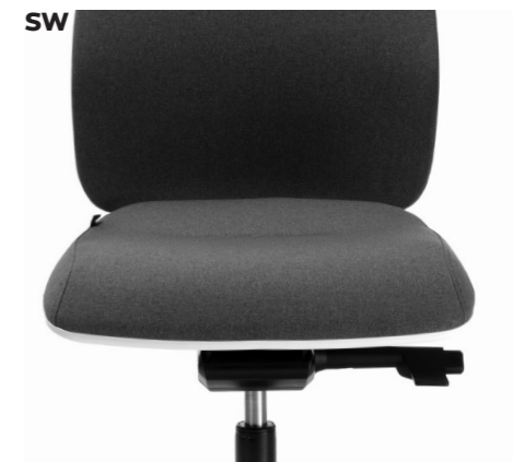
SW Mechanizm synchro-samoważący z blokadą oparcia w 5 położeniach (zakres regulacji kąta odchylenia oparcia 20° i siedziska 6°), oraz regulacją głębokości siedziska (zakres 60 mm). Mechanizm nie wymaga regulacji siły odchylenia oparcia. Mechanizm rozpoznaje wagę użytkownika i automatycznie dostosowuje do niej synchroniczne odchylenie oparcia i siedziska.
