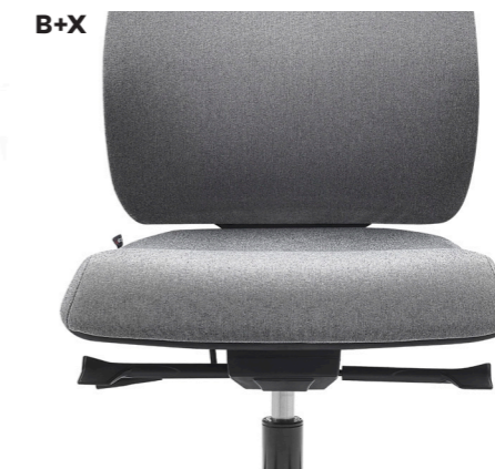
B+X Mechanizm synchro-samoważący z blokadą oparcia w 4 położeniach (zakres regulacji kąta odchylenia oparcia 20° i siedziska 5°), oraz regulacją głębokości siedziska (zakres 58 mm). Mechanizm nie wymaga regulacji siły odchylenia oparcia. Mechanizm rozpoznaje wagę użytkownika i automatycznie dostosowuje do niej synchroniczne odchylenie oparcia i siedziska.
